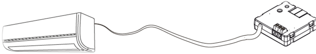
Figura 2. Conexión del KLIC-DD V3 a la máquina de A/A.
